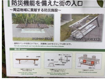
⑫かまどベンチ。(通常はベンチ、災害時は炊き出し用のカマドに)
